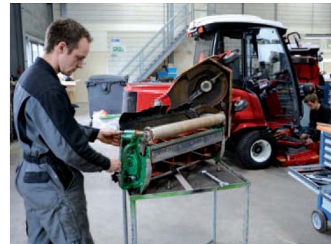
Om het maaibeeld van een kooimaaiër goed te houden, is regelmatig onderhoud nodig.
