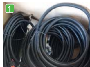
1 In dozen De gewassensensoren die Ag Leader levert, komen aan in drie dozen. Twee dozen bevatten de sensoren en de communicatiemodule en één doos de bekabeling. Deze kabels vormen het zogeheten harnas. Dat harnas levert stroom en transporteert de data van de sensoren. De set bevat ook verlengkabels en een montagehandleiding.
