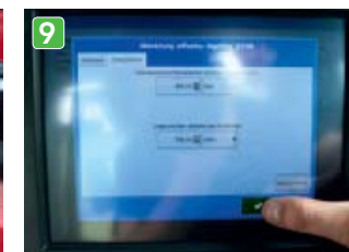
9 Systeem initialiseren Geef in de gps-terminal aan hoeveel sensoren zijn geplaatst. De terminal herkent ze zelf, maar de juiste plaats van de sensoren moet je wel ingeven. De terminal krijgt plaatsgegevens van de een eigen gps-antenne maar kan ook worden gevoed door een bestaand gps-systeem. Vaak is dan een specifieke verloopkabel nodig.
