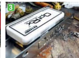
3 Ventilatiegaten vrijhouden De rvs-houders voor de gewassensensoren zijn door leverancier Louis Nagel al op maat gemaakt. Dat scheelt tijd. Maak je de houders zelf houdt dan rekening met gaten voor bevestiging, camera, lichtbronnen en ventilatie. Dek je de ventilatiegaten af, dan kan er condens in de sensoren ontstaan, waardoor op juiste meetwaarden ontstaan.
