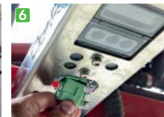
6 Vrij zicht op het gewas Als het harnas op de spuitmachine is gemonteerd, kun je de sensoren aansluiten. Vanaf de rijrichting gezien komt sensor 1 links op de boom, sensor 2 rechts. Monteer je ze andersom, dan komen de gegevens van de linker sensor rechts op de kaart en andersom. Monteer de sensoren zo dat buizen, slangen en leidingen het zicht niet verstoren.
