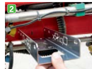
2 Uitmeten Om de juiste data te verzamelen moeten de gewassensensoren evenredig over de spuitboom worden bevestigd. Bij twee sensoren op een 39 meter spuitboom, plaats je ze dus beide op 9,75 meter van de boomtip. Hoe meer sensoren hoe nauwkeuriger en betrouwbaarder de metingen. De sensoren moeten vrij zicht op het gewas hebben.
