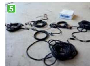
5 Harnas aansluiten Het harnas is compleet. Dit netwerk zorgt voor de stroomvoorziening van de sensoren en het transport van de data van de sensoren naar het beeldscherm in de cabine. Gelukkig geeft een handleiding aan welke kabels en stekkers je moet gebruiken, in welke volgorde je ze aan elkaar moet bevestigen en waar je de eindstoppen moet plaatsen.
