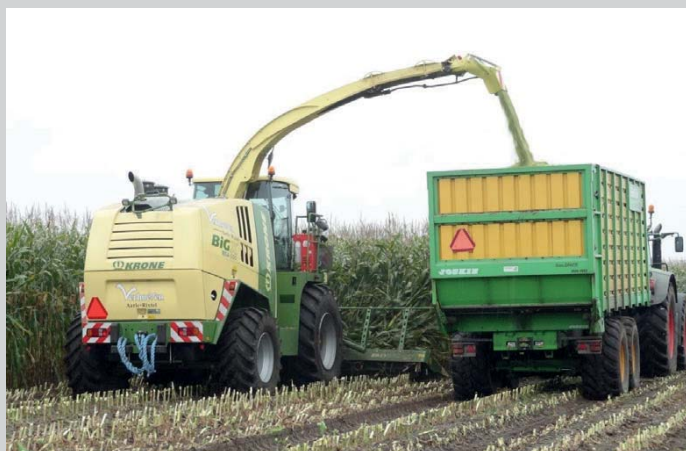
Krone heeft met de VariStream - de verende achterwand van de hakselkooi en de blazer - een unieke troef. Tel daar de oversized MAN-motor nog bij. Krone heeft flink geïnvesteerd in een nieuwe productielijn, service en scholing als bewijs dat de hakselaar voor het merk belangrijk is.
