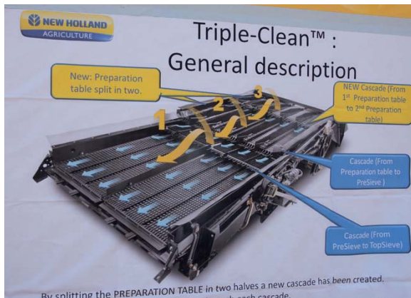
De doorsnede-tekening van de CX5000 en CX6000-serie met op de voorbereidingstafel een extra cascade om de reinigingscapaciteit te vergroten.
