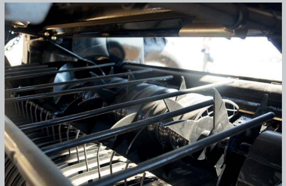
De ActiveSweep-invoer, met een laag liggende invoerrol net achter de pickup
