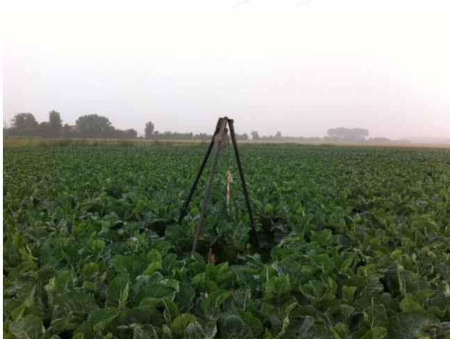
Figuur: meting van de geleidbaarheid van de ondergrond (maat voor het zoutgehalte van het grondwater), d.m.v. een sonde in een peilbuis. Hiermee wordt een beeld verkregen van de dikte van de zoetwaterbel in de kreekrug, voor en na de infiltratieproef.
