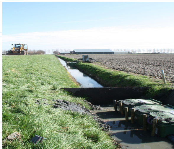
In afvalbakken wordt water uit drainagebuizen en sloot opgevangen en gemeten
