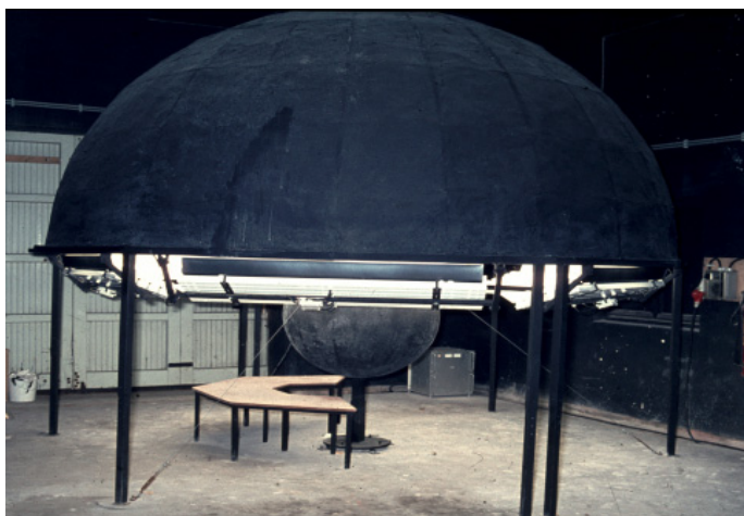
Figuur 1. Grote integrerende kogel voor metingen van lichttransmissie en reflectie van een transparant materiaal.
