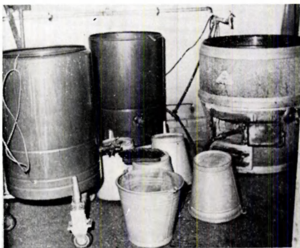
Mengketels voor het bereiden van de kunstmelk worden bij kalvermesterij van enige omvang overal gebruikt. De verwarming van het water geschiedt op verschillende manieren. Hier gebeurt het in een moderne fornuispot, met aardgas als warmtebron
