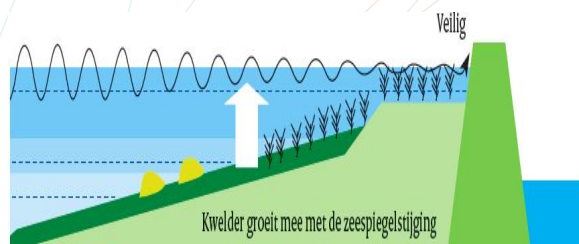
Dijk met kwelder (bron: RWS)
