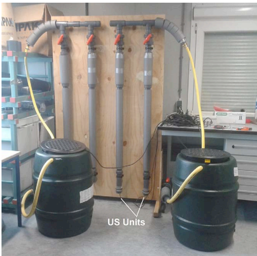
Afbeelding 2. De proefopstelling, bestaande uit twee aparte systemen
