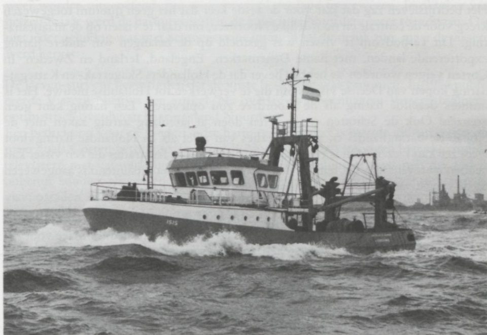
Voor het onderzoek in de kustwateren kwam in 1983 de 'Isis' in de vaart. Het is een kleine hekkotter met een motorvermogen van 800 pk.
