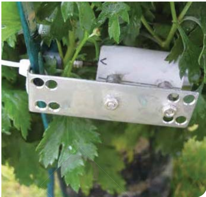
▲ Foto 1: LVDT-sensor op de stengel bij chrysant
