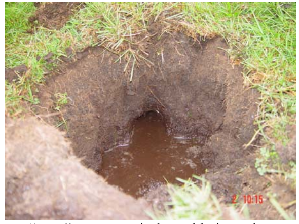
De "gang" van waaruit de moldrainage bestaat
