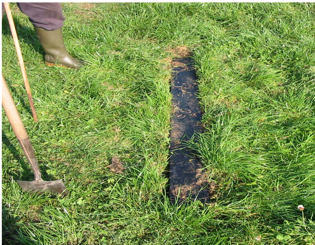
Figuur 16 afwerking van de meetopstelling in het veld. Het deksel van houtenbak wordt gelijk met maaienveld geplaatst.
