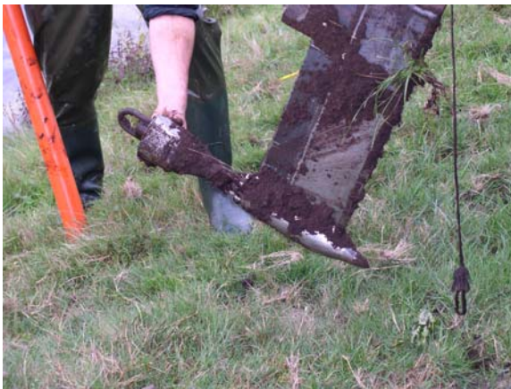
De conus waarmee een "gang" wordt getrokken door het bodemprofiel
