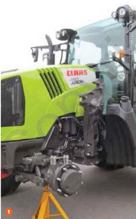
1 Ook na de opbouw van de frontladerconsoles blijft de Arion 400 zijn smalle taille behouden. 2 De Hitch-trekhaak wordt door een aparte horizontale cilinder opgetild. Het systeem is vergelijkbaar met een hefmast van een heftruck.
