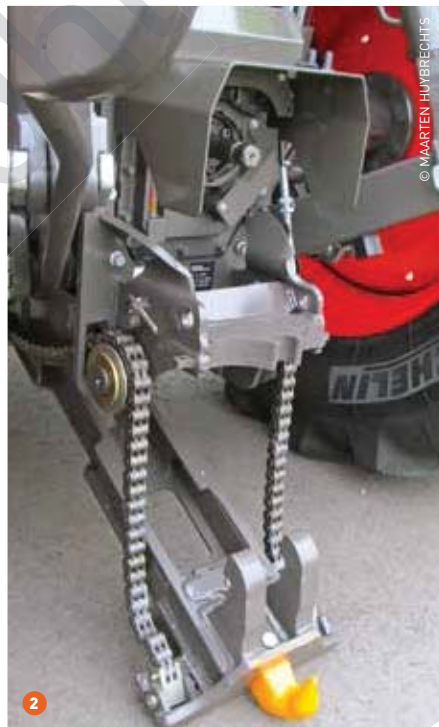
1 Ook na de opbouw van de frontladerconsoles blijft de Arion 400 zijn smalle taille behouden. 2 De Hitch-trekhaak wordt door een aparte horizontale cilinder opgetild. Het systeem is vergelijkbaar met een hefmast van een heftruck.
