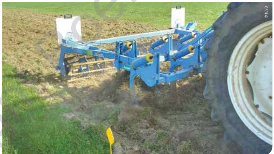
Vernietiging van de gras-kloverzode met een Actisol met vleugelscharen gemonteerd op de tanden.
