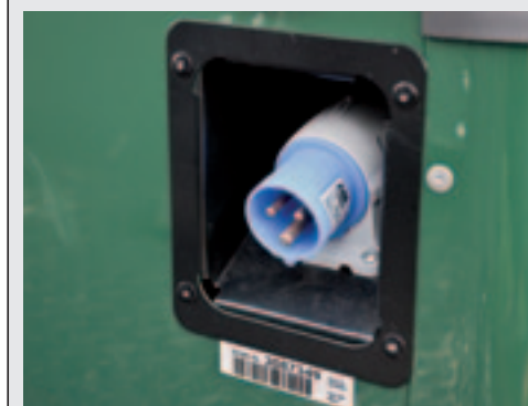
De oplader zit onderhuids. Je hoeft dus niet te sjouwen met een zware oplader.
