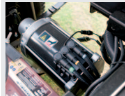
De motor op wisselspanning is direct op de achteras gemonteerd.
