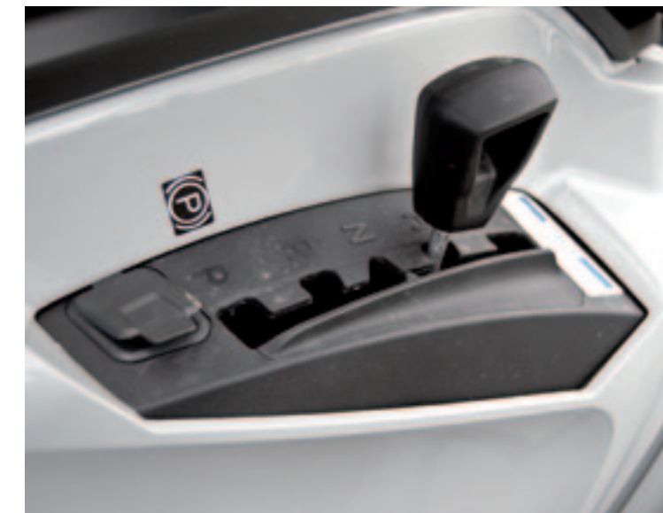
Rechts van de bestuurder zit deze pook om te schakelen tussen hoog, laag en achteruit. Schakelen vraagt wat inspanning.
