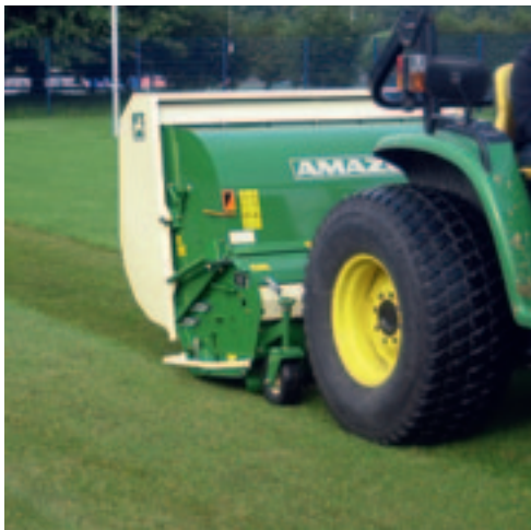
De gemeente Schijndel maait de sportvelden ultra kort met een Amazone Grasshopper. Het maaifrezen zorgt er tevens voor dat velden vlak blijven. Dressen is minder vaak nodig.
