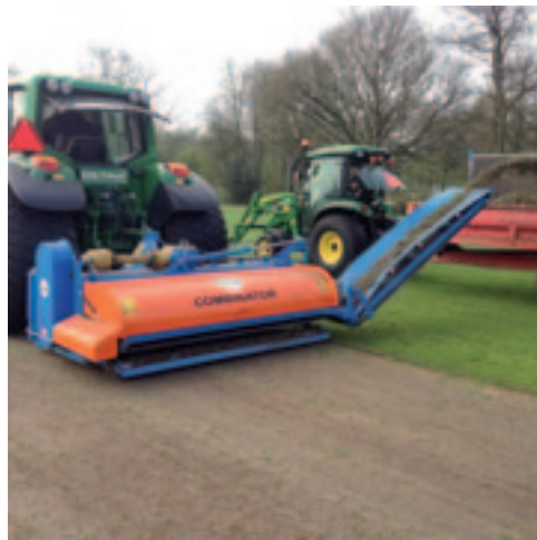
Het affrezen van de top laag in het kader van de 'Dutch method' is goed te combineren met eco-dressen waarbij de grond die vrijkomt bij het beluchten op het veld blijft.
