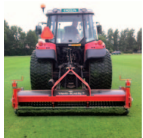
Engelen Groen Uden liet Redexim een machine bouwen die belucht met twee rijen snijdende schijven. Zo worden ook nog niet volgroeide zoden gesneden en belucht.
