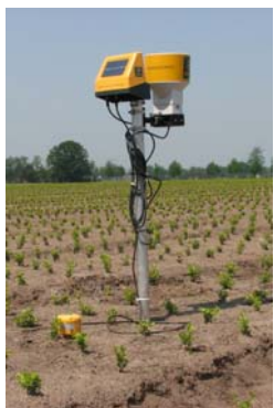
Dacom vochtsensor geeft een actueel inzicht in het vochtgehalte in de bodem.
