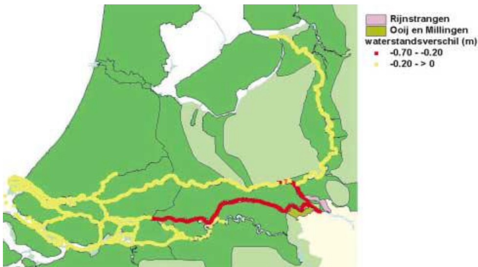
Figuur 3,11: Effect van de inzet van de Ooijpolder en Rijnstrangen als noodoverloopgebieden bij een afvoer van 16000m 3 /s
