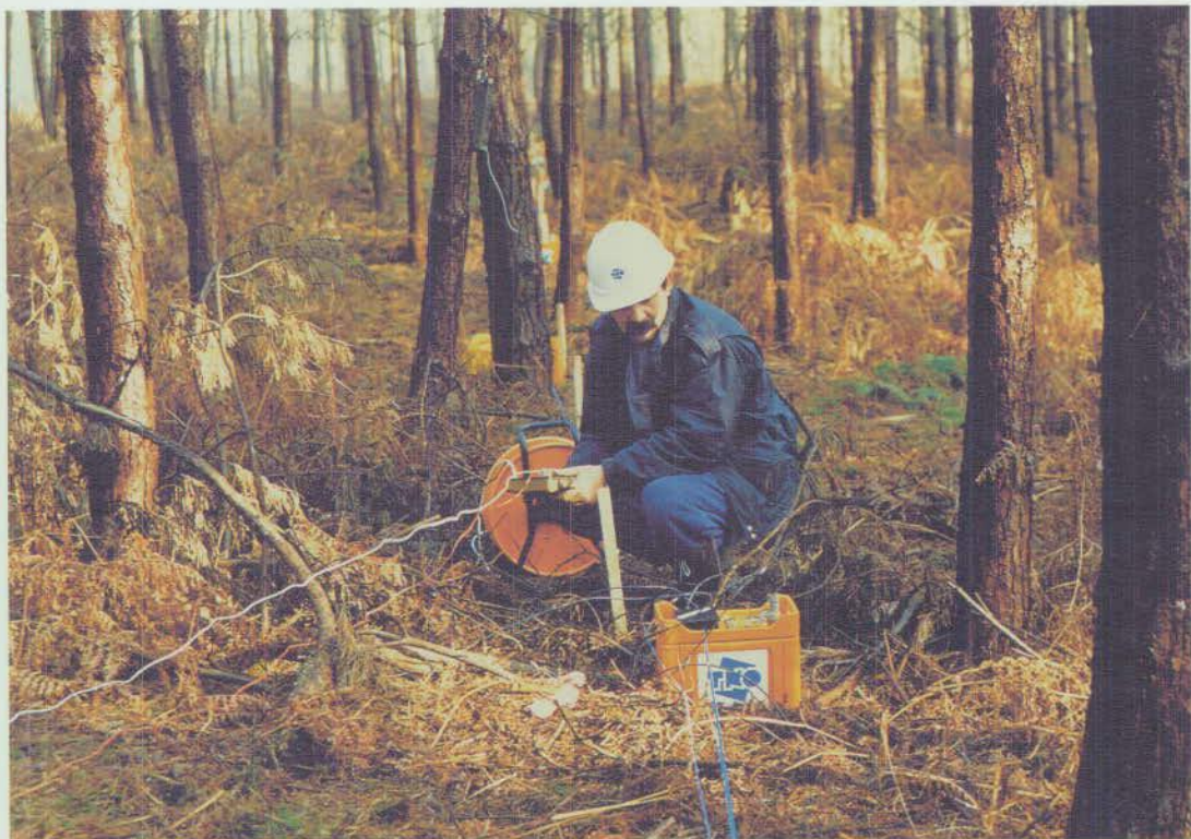
TNO'er bezig in het Edesche Bos met het tot ontsteking brengen van een springlading ten behoeve van seismisch onderzoek.
