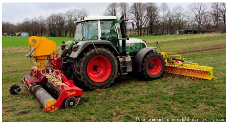
Doorzaamachine met dubbel schijvensysteem
