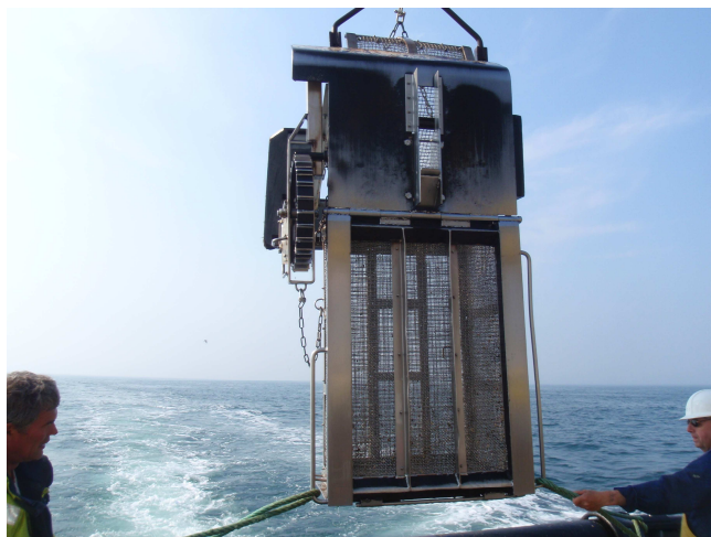
Figuur 2 Monstername met de bodemschaaf aan boord van de ISIS
