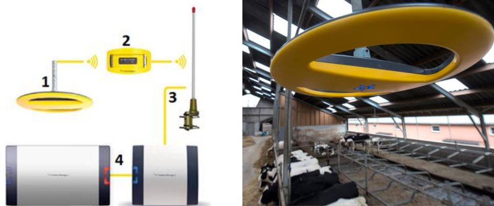
Figuur 1 Links een schematische weergave van de werking van het Nedap plaatsbepalingssysteem, 1= baken, 2= halslabel, 3= antenne, 4= procescomputer. Rechts een van de bakens in een stal (Nedap, 2013).
