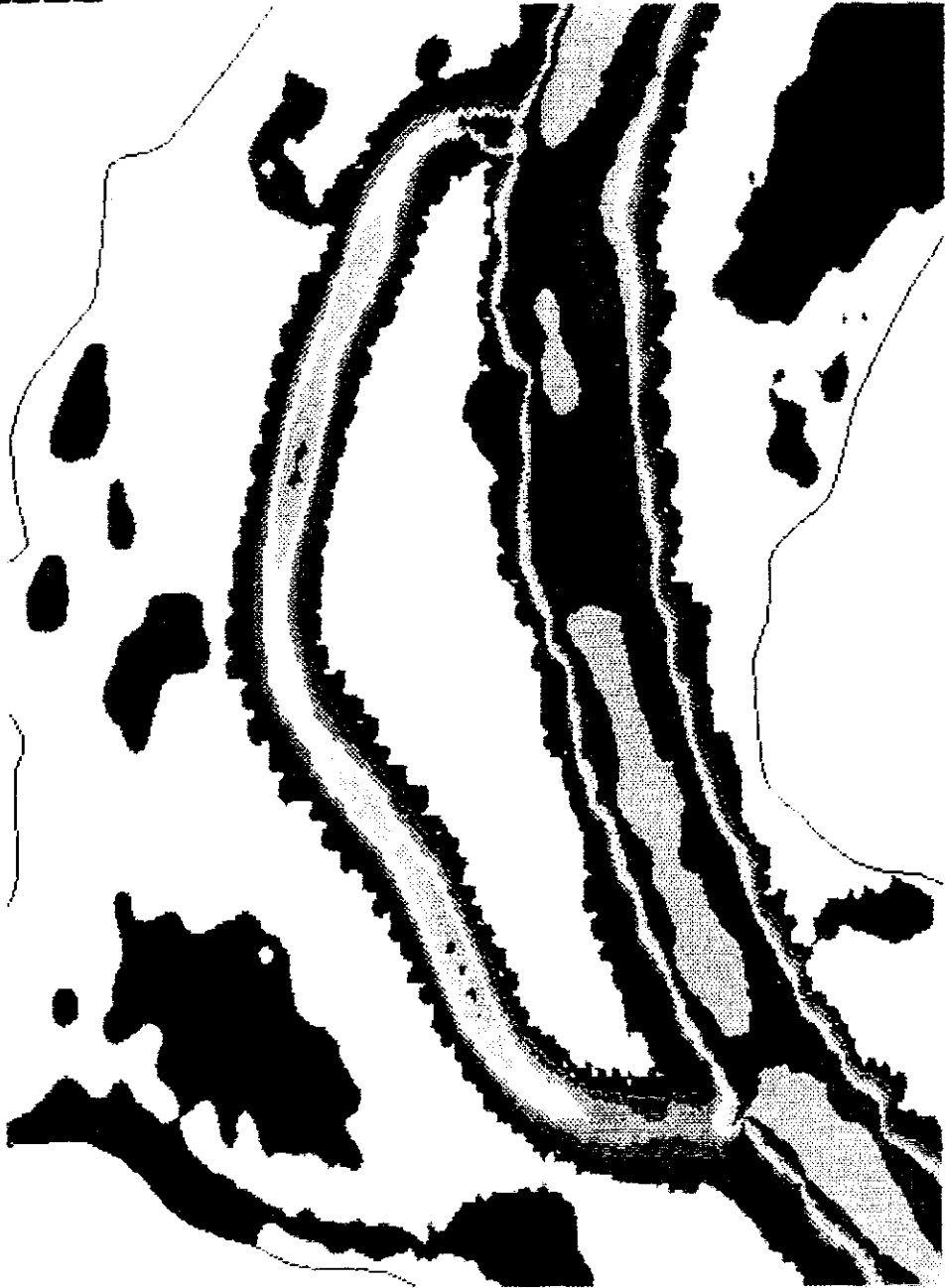
bijlage 8: stroomsnelheidsgrootten bij Waalafvoer van 1356 m 3 /s
