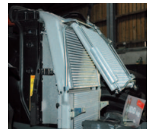
^ Koelpakket makkelijk te reinigen De voorste koeler klapt naar voren, waarna de airco- en de interkoeler via een 'deurtje' van achter uit zijn schoon te blazen.
