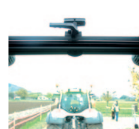
^ Prima zicht naar voren en naar boven De cabine stijl tussen de grote voorruit en het grote dakraam is smal, waardoor er een prima zicht is op een eventuele voorlader.
