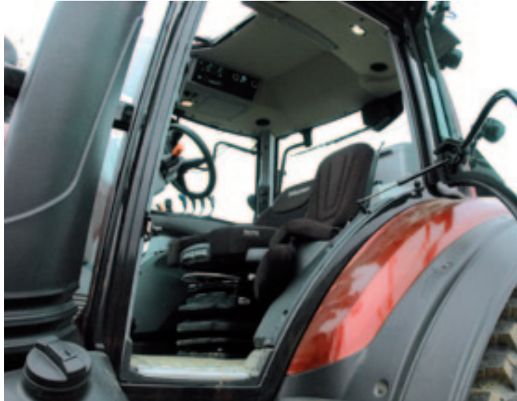
^ Nieuwe stille cabine met veel binnenruimte en veel glas Het geluidsniveau in de cabine van de nieuwe T4 blijft volgens Valtra steeds onder de 70 dB(A). De leefruimte is groot: ook een rijder past er goed in. Een koelbox af-fabriek is een optie.
