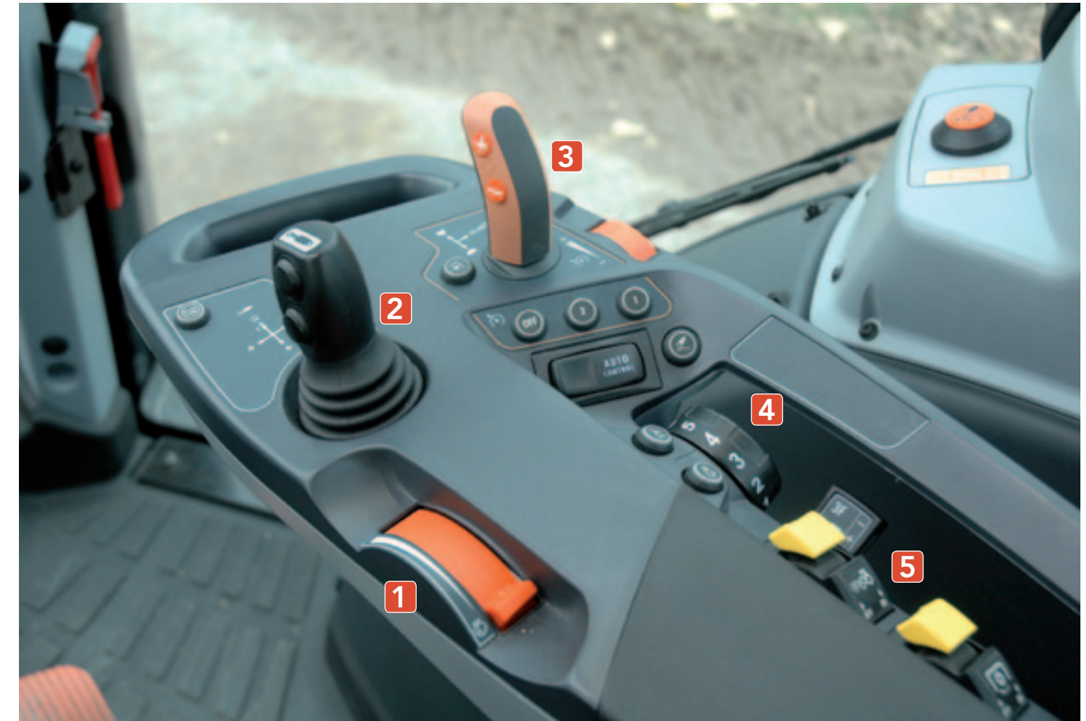
^ Alle bedienelementen overzichtelijk op de rechter armleuning Handgas [1] en joystick [2] voor het bedienen van de ventielen. Rechts daarvan het pookje [3] voor de vijf powershiftstappen en de vier groepen. Voor- of achteruit is de powershift te versnellen of te vertragen; naar rechts is de automatiekstand. De plus-/min knopjes zijn voor de groepen. Naast de handgas de draaiknop [4] voor de hefhoogte. Met de gele knoppen [5] schakel je de aftakassen voor en achter in en uit het werk.
