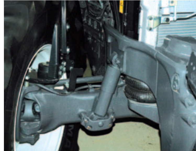
^ Frame met twee wespentailles langs de motor Het frame buigt bij de vooras voor en na de radiator naar binnen. Daardoor halen de voorwielen hun maximale stuuruitslag; dat stuurt scherp. De pneumatische voorasvering met dempers is een optie.
