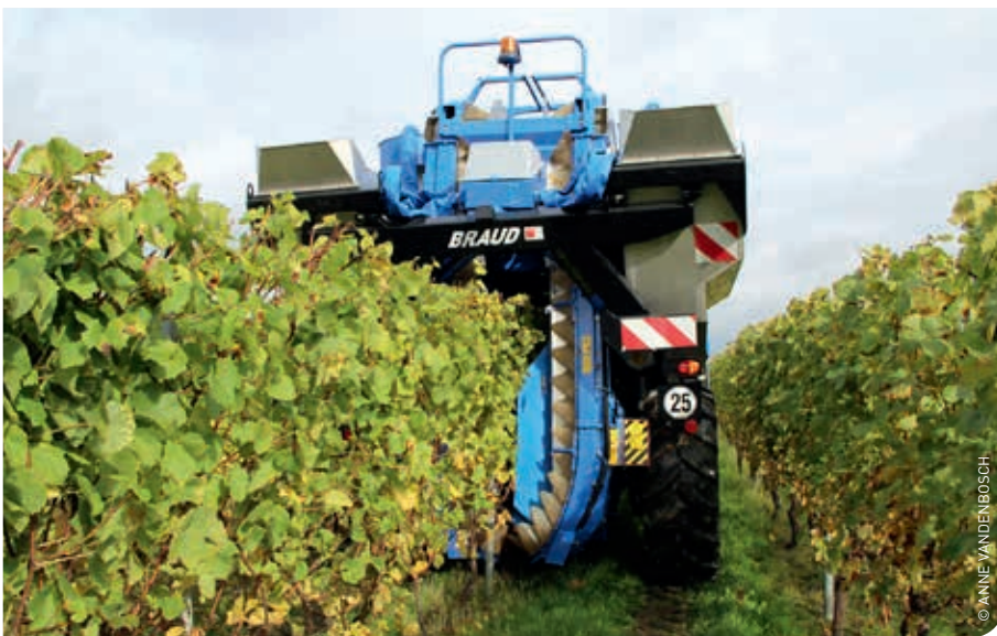
Achteraan de plukker gaan de gevulde bakjes naar boven. Via een transportband belanden de druiven in de verzamelbakken aan weerszijden van de machine.
