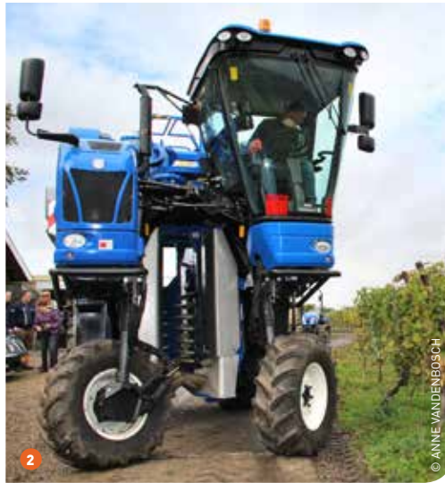
1 Mathieu Hulst van de Apostelhoeve "Ik ben ervan overtuigd dat deze machine mijn slagkracht verhoogt. Ik kan de plukker op het ideale moment inzetten." 2 De machine is erg wendbaar dankzij voorwielen die tot 90 graden draaien. Het hart van de machine zijn de 14 schudlatten, met onderin flexibele bakjes die de druiven opvangen
