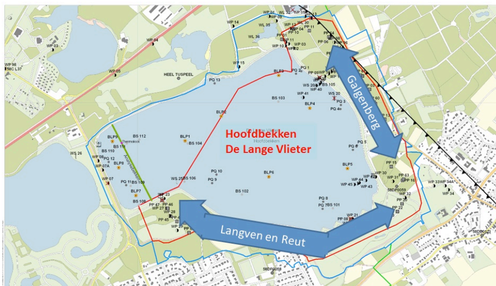
Afbeelding 2. Overzicht van De Lange Vlieter en de ligging van de twee ruwwatersecties Galgenberg en Langven en Reut, waarin het onttrokken water uit verschillende putten wordt verzameld bij productielocatie Heel.
