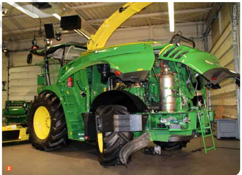
1 De nieuwe hakselaar werd onder typisch Belgische omstandigheden getoond aan pers en loonwerkers. 2 De John Deere PowerTech PSX-motor werd in de lengterichting geplaatst, achter de achteras. Het zorgt voor een betere stabiliteit en het zicht naar achteren verbetert. Wanneer de chassisleppen opengezet worden is hij langs alle zijden goed bereikbaar. Krachtige lampen zorgen voor een goed zicht op de binnenzijde van de hakselaar.
