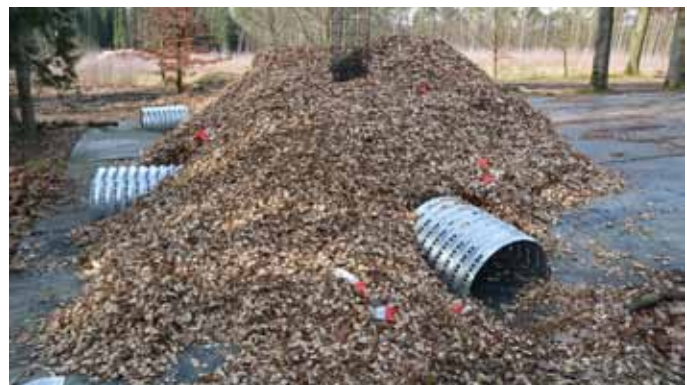
Opslagproef kleine eiken chunks met het Dombelüftungsverfahren.
