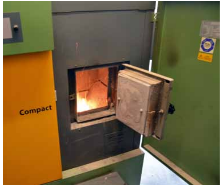
Stook- en doorvoertest kleine eikenchunks in houtsnipper CV-ketels met vijzelinvoer.
