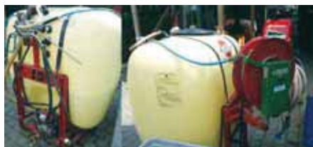
Omgebouwde veldspuit met lans: geen spuitboom meer aanwezig! (vrijgesteld van keuring)
