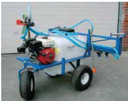
Getrokken motorvatspuit met spuitboom
