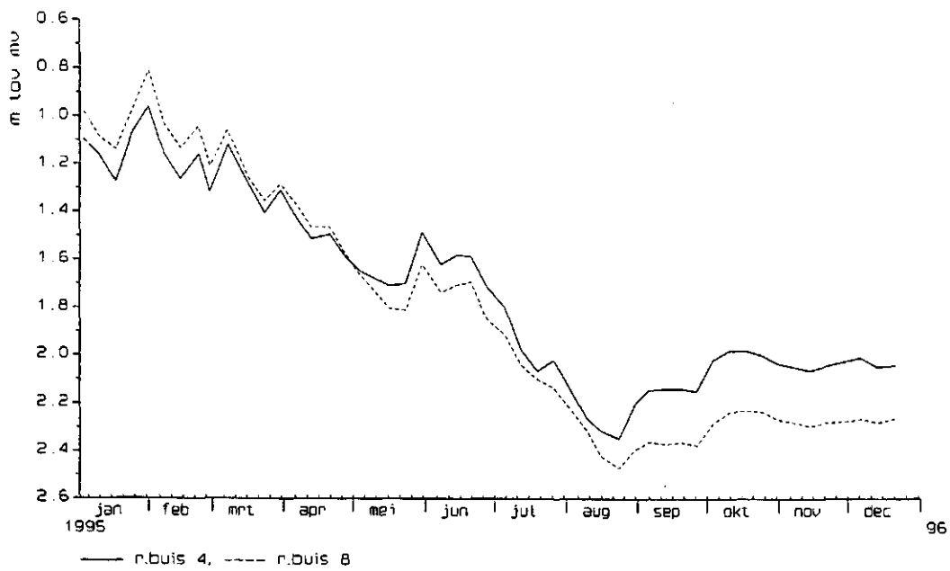
Fig. 62a Verloop grondwaterstand t.o.v. maaiveld in referentiebuis 4 en 8
