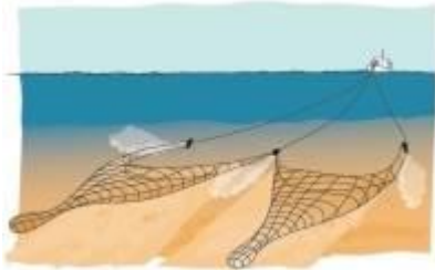
Figuur 9 Schematische weergave twinrig visserij. Figuur verkregen via http://www.goedevis.nl/veelgestelde-vragen/vangstechnieken op 8 juli 2014
