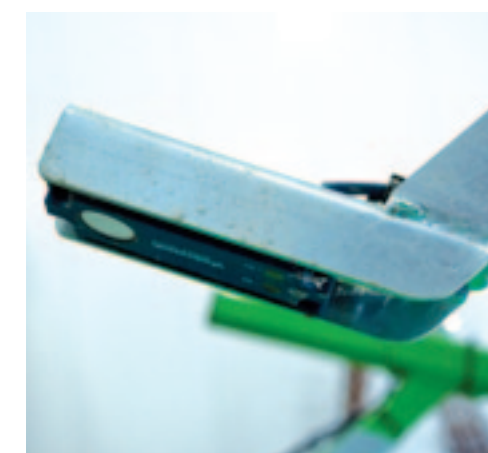
^ Sensoren Boven de bunker hangen twee sensoren die de belastingtoestand van de bunker in de gaten houden.
