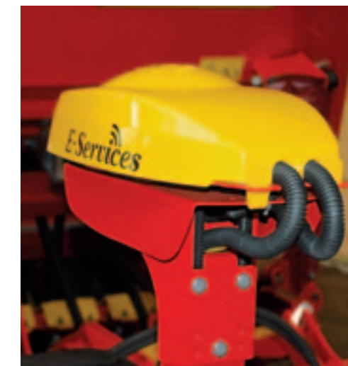
^ Wifi en gps in één kastje De nieuwe Rapid-zaaimachine is te bedienen via de iPad. De machine levert zelf het wifi-sigitaal dat daarvoor nodig is.
