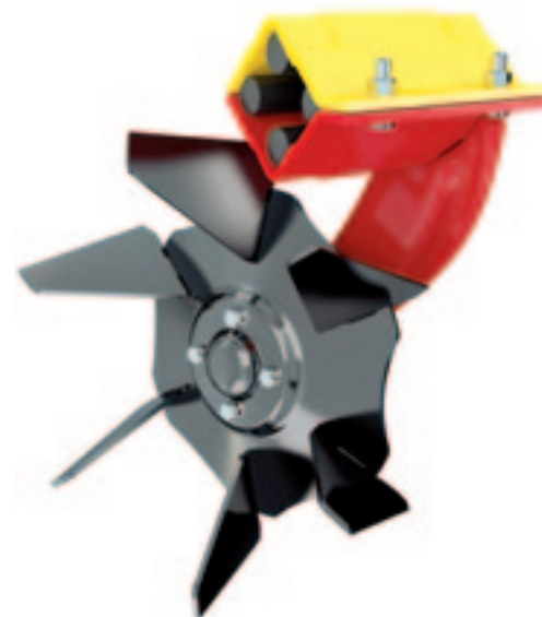
^ Crosscutter-disc De Crosscutter-schijf werkt over 11 cm breedte gelijkmatig diep. Een gewone schijf werkt maar op één punt op de juiste diepte.
