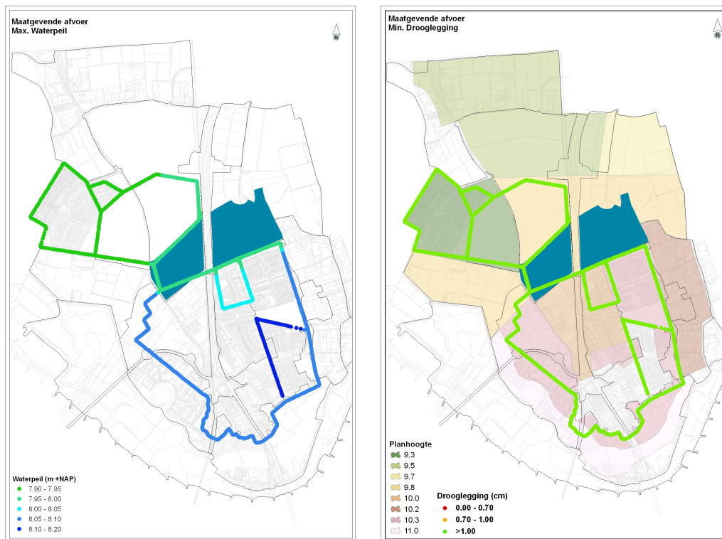
Figuur B14.8 en 9: Resultaten bij maatgevende afvoer
