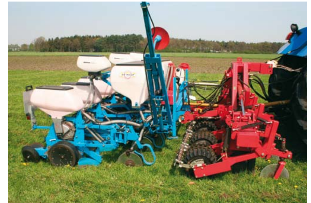
De Hunter van Evers-Agro met een schijfkouter en woelpoot gevolgd door een monosem zaaimachine. In combinatie met een bespuiting van de graszode vooraf aan inzaai en de normale maïsbespuiting levert dit een werkzaam systeem op.
