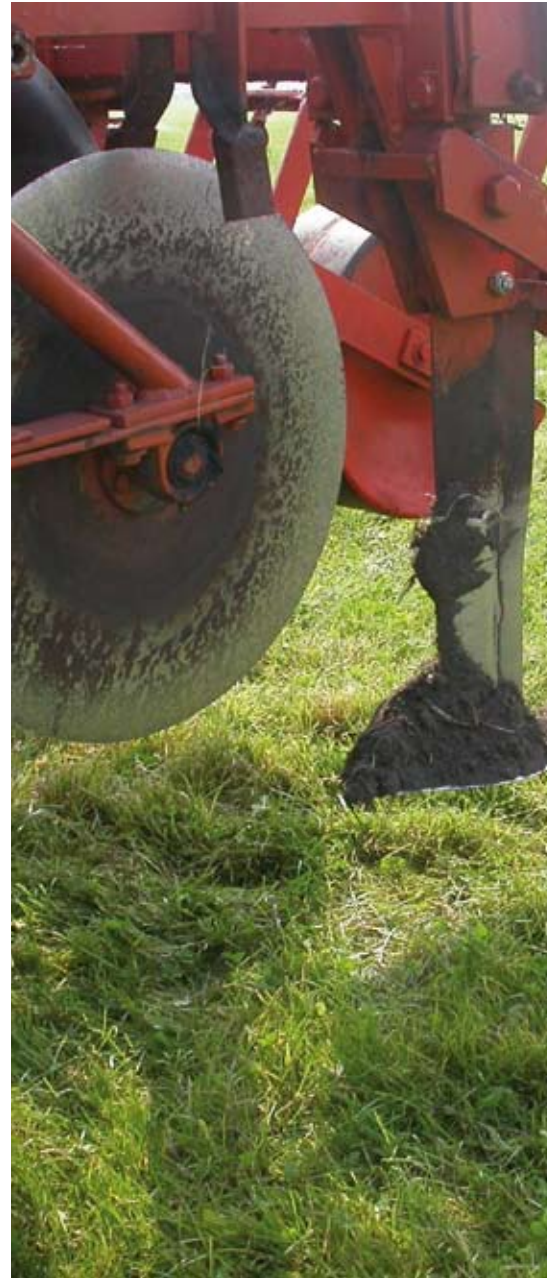
Er zijn verschillende beluchtingsmachines of graslandwoelers in de handel. Een omgebouwde mestinjecteur kan ook het werk doen.
