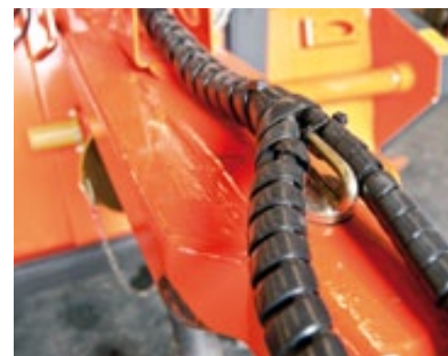
■ Sport en Recreatie Rotterdam heeft de dissel verbreed om de aftakussen te beschermen.
