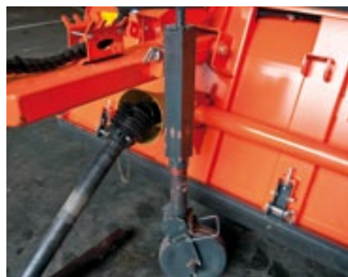
■ Sport en Recreatie Rotterdam monteerde het steunwiel dicht bij de machine.
