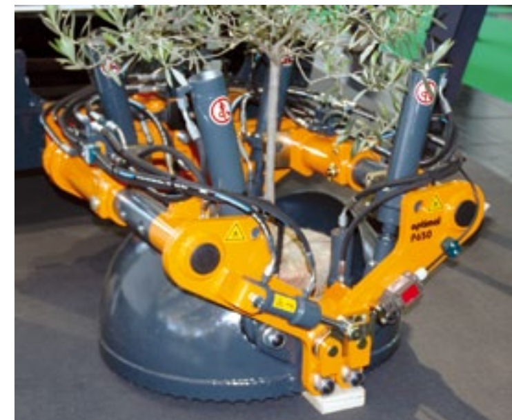
De kluitklem Optimal P650 (foto links) is geschikt voor kleine wielladers en komt daarmee binnen het bereik van de hovenier. De P650 zit in dit geval gemonteerd aan de laadarm van een Terex PT30-schranklader met een motorvermogen van 23,5 kW (32 pk). De leverancier van de klem is de Optimal-Vertrieb Opitz in Thalmaessing. Een grotere versie van de Optimal, de 1100, zat aan een 7-tons Terex TL120 met 74 kW (100 pk).
