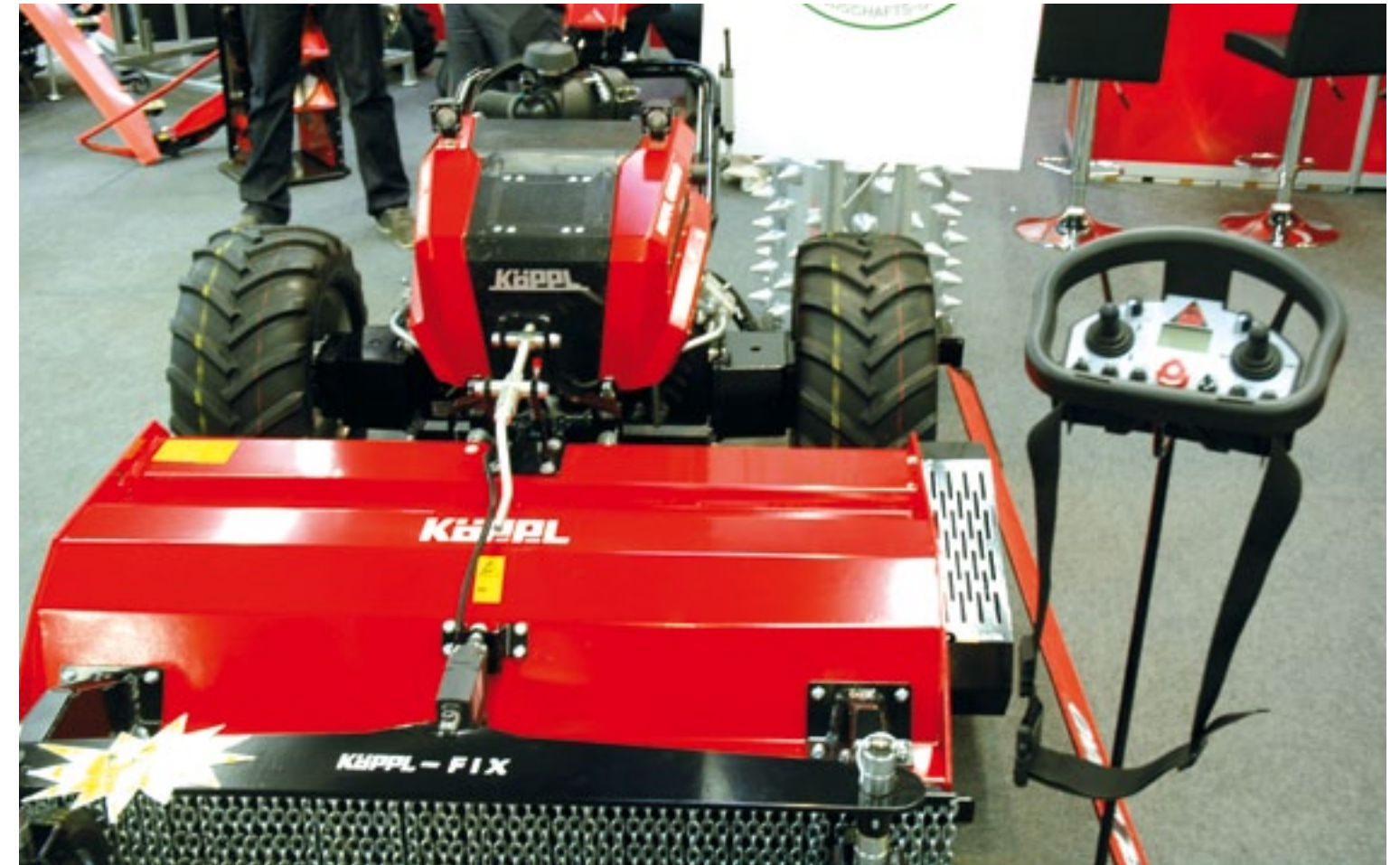
De Gekko van Köppl wordt radiografisch bestuurd. Gevaarlijk werk op taluds of hellingen kan deze éénasser alleen doen. De bestuurder blijft op veilige afstand. De hydrostatisch aangedreven Gekko heeft een verschuifbare as met een slag van 200 mm. Daardoor is voor elk werktuig een goede gewichtsverdeling in te stellen. De motor van de Gekko levert 17 kW (23 pk) en de snelheidsbereiken zijn van 0 tot 8 km/h voorwaarts en 0 tot 4 km/h achterwaarts.
