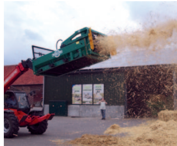
De spread-a-bale valt op doordat hij de balen uit elkaar harkt door middel van stalen rotors. De machine kan aan zowel de zijkant als voorkant aangekoppeld worden aan een shovel of verreiker.
