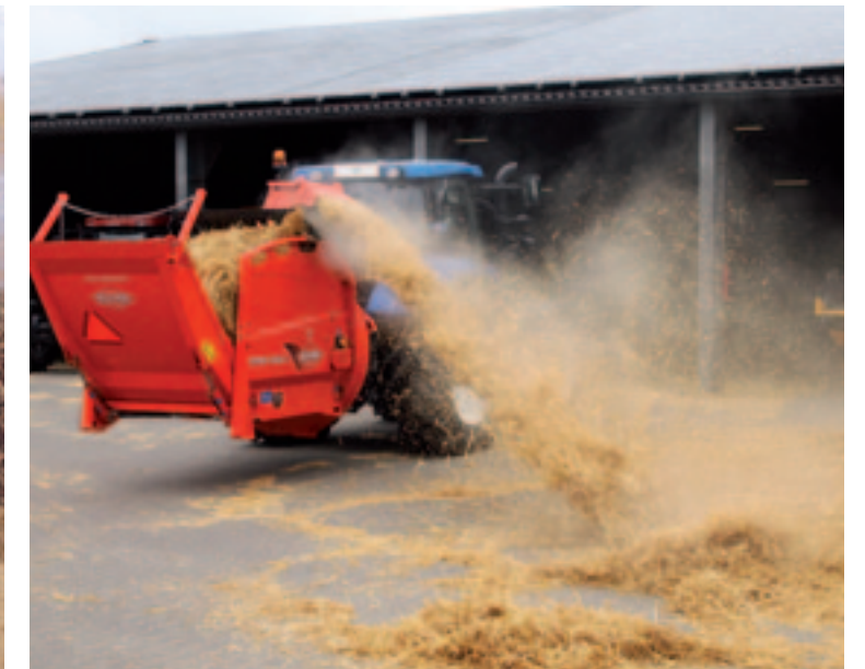
De Kuhn Primor kent een 2-kuubs-variant die zowel in de hef als op wielen kan. De 3,5- en 5,5-kuubs-varianten zijn beide getrokken. Wat tijdens de demo opviel was de herrie van de laadklep bij het laden.
