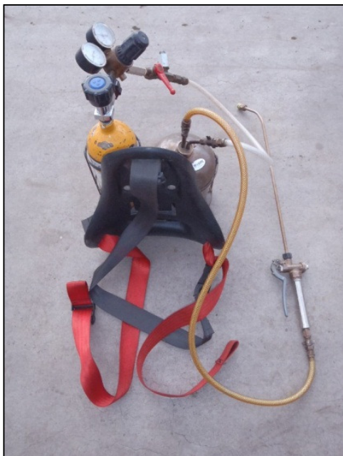
Figuur 3.2: Handgedragen perslucht ondersteunde proefveldspuit
