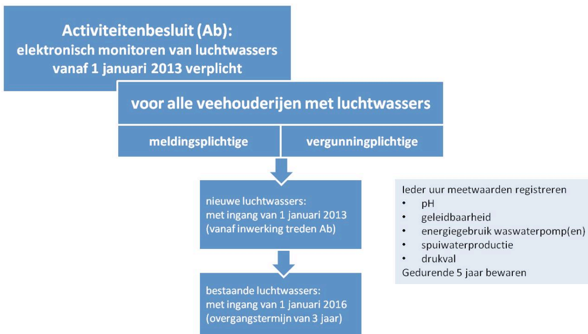
Figuur 4. Elektronisch monitoren van luchtwassers is onder het Activiteitenbesluit wettelijk verplicht. De vijf parameters genoemde moeten ieder uur worden geregistreerd, opgeslagen en vijf jaar worden bewaard.
