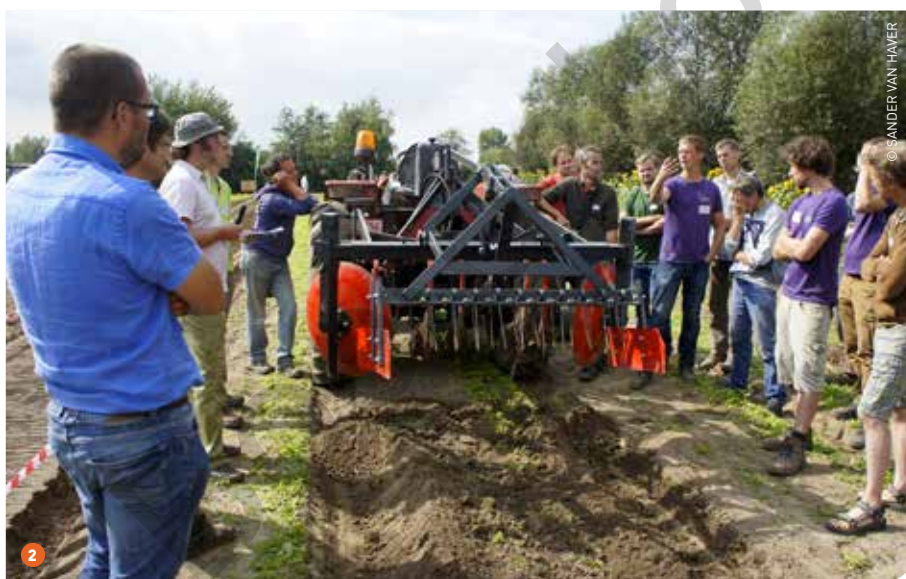
1 De Forigo-beddenfrees legt vlakke en licht aangedrukte teeltbedden aan, klaar om in te zaaien of te beplanten. 2 De Culti-butte-beddencultivator legt in één beweging een verkruid en verhoogd teeltbed aan.
