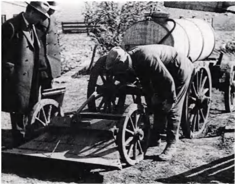
De gierkar van Veltman, een apparaat om dunne mest (gier) op het land te verspreiden (1933): het sproei-apparaat wordt bevestigd aan de gierkar.
