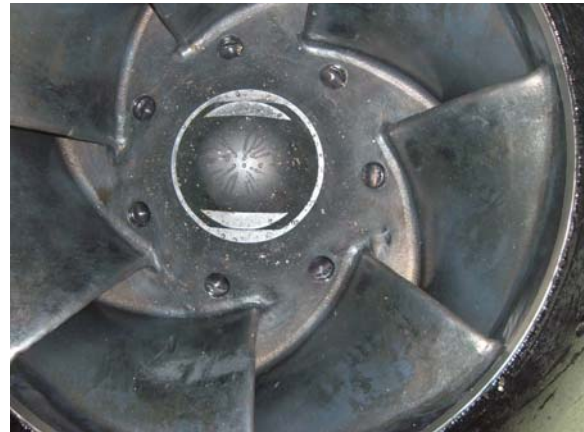
Figuur 1.6. De waaiers van de pompen laten geen grote propfen vuil door.
