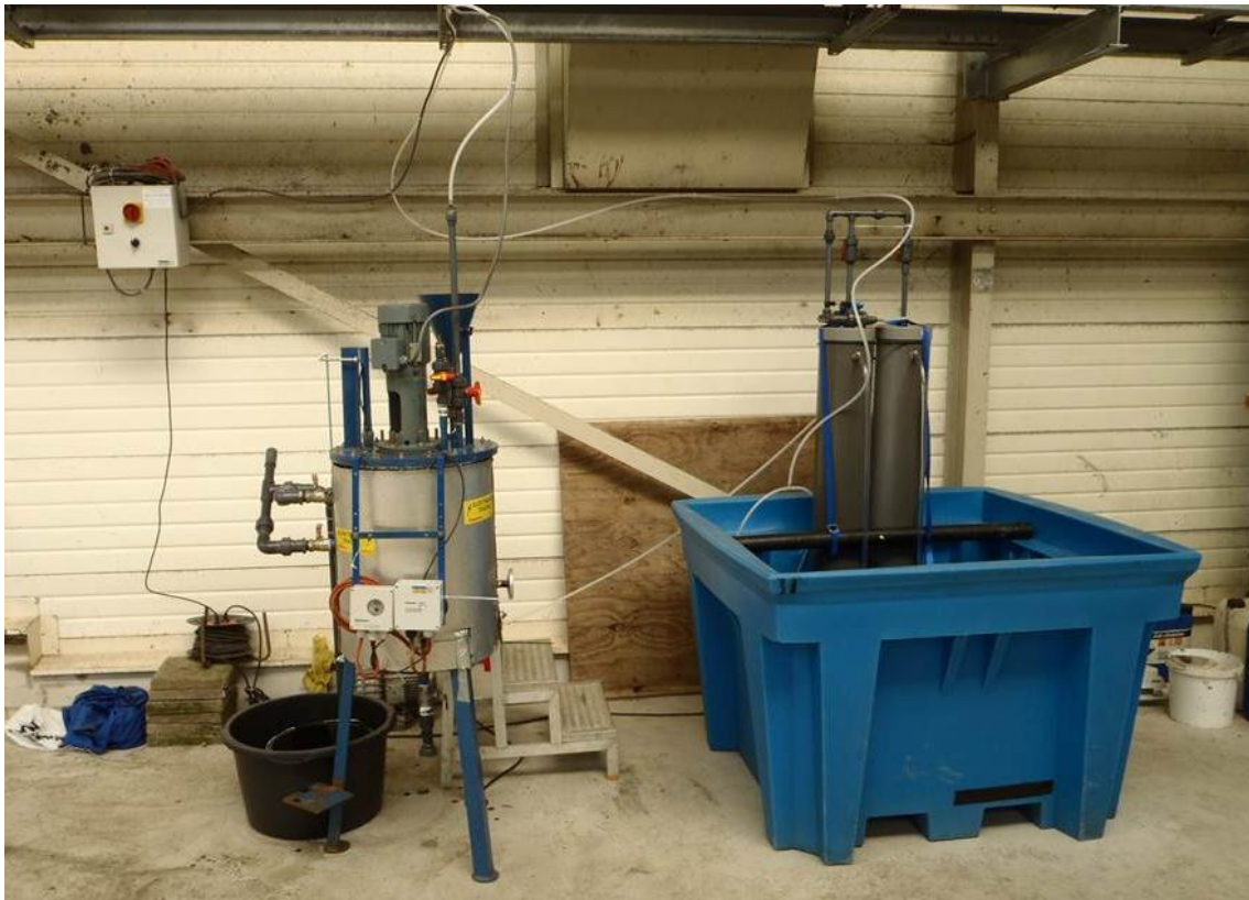
Figuur 2.5. Pilotopstelling thermofiele gisting Bath
