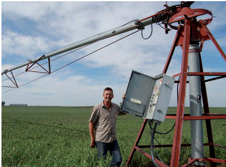
Hans Wesseling legt de bediening van de pivot uit. De wielen worden elektrisch aangedreven. De boom is 400 meter lang en bestrijkt een oppervlakte van ongeveer 60 hectare.
