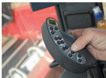
De bediening van de Massey Ferguson Cerea 7278 AL bevindt zich op de rijhendel, de Multifunction Lever.
