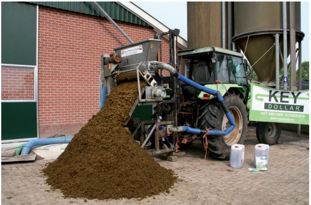
De mobiele mestscheider van Roubos Mesttechniek scheidt de mest via het wringerprincipe.
