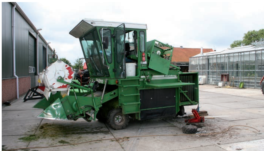
De Haldrup-hakselaar is uitgerust met Nirs, zodat de kwaliteit van het gras kan worden bepaald.
